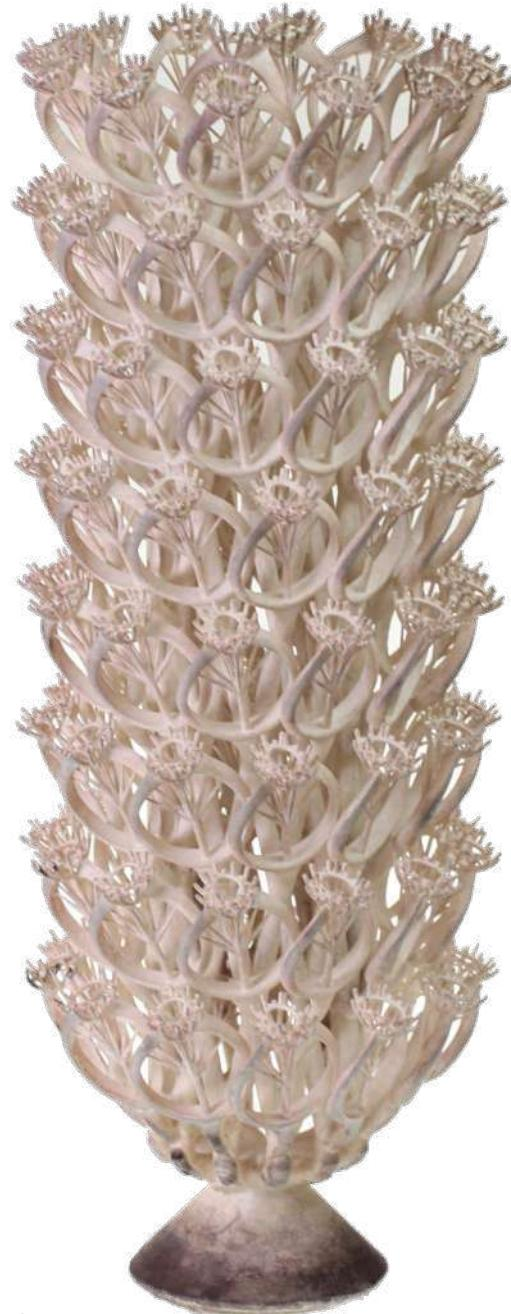
La produttività al servizio della precisione. Un sistema unico. Il sistema cluster di DWS permette di mantenere l'altissima definizione e rispetto dimensionale, aumentando la produttività nello sfruttare la costruzione in asse Z. Il sistema utilizza i canali di fusione come supporti, potendone variare le dimensioni e i diametri per ottimizzare la produzione. Grazie al software, NAUTA XCLUSTER, uniamo la massima definizione a un'alta produttività.
