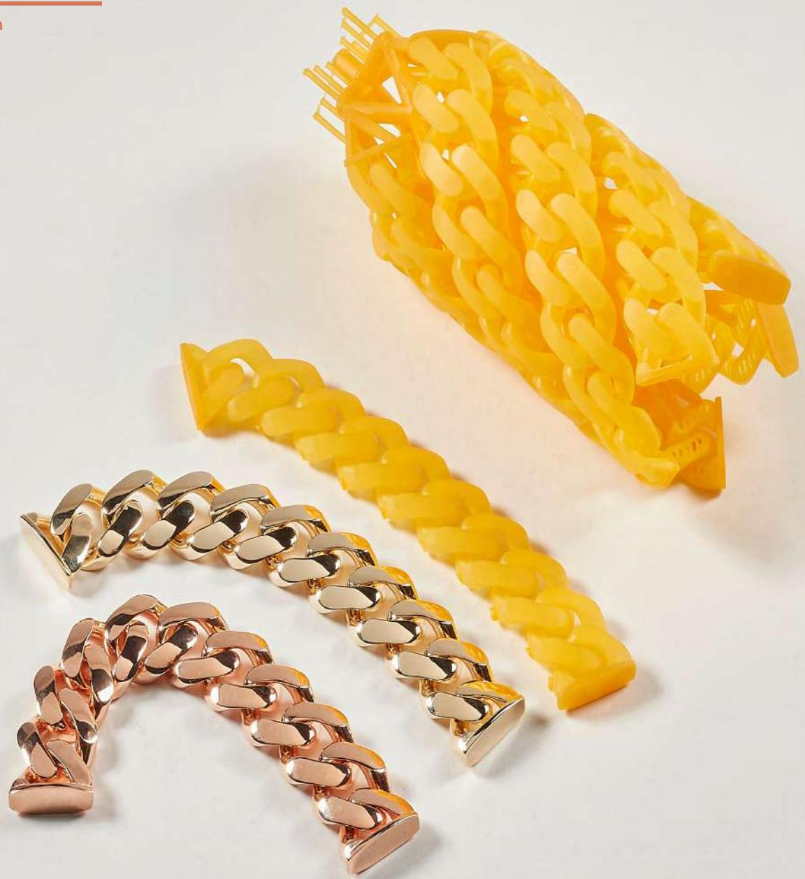
Con il sistema NAUTA XCLUSTER Chain, DWS permette di stampare catene di diverse dimensioni e disegno in resina fondibile. Catene complete di chiusure e terminali, già ammagliate, senza necessità alcuna di saldature e vuote al loro interno. Supporti che fungono da canali di fusione, alta definizione, alta produttività e costi contenuti.
