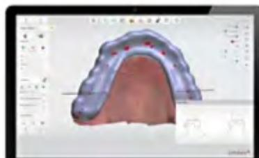
Per aiutarti a bilanciare lo spessore minimo del materiale e il design più sottile possibile per il comfort del paziente, **Splint Studio** ti avvisa se lo spessore minimo che hai scelto è sovrastato in tutto il design. Indica discrepanze e le corregge automaticamente, se lo si desidera.
